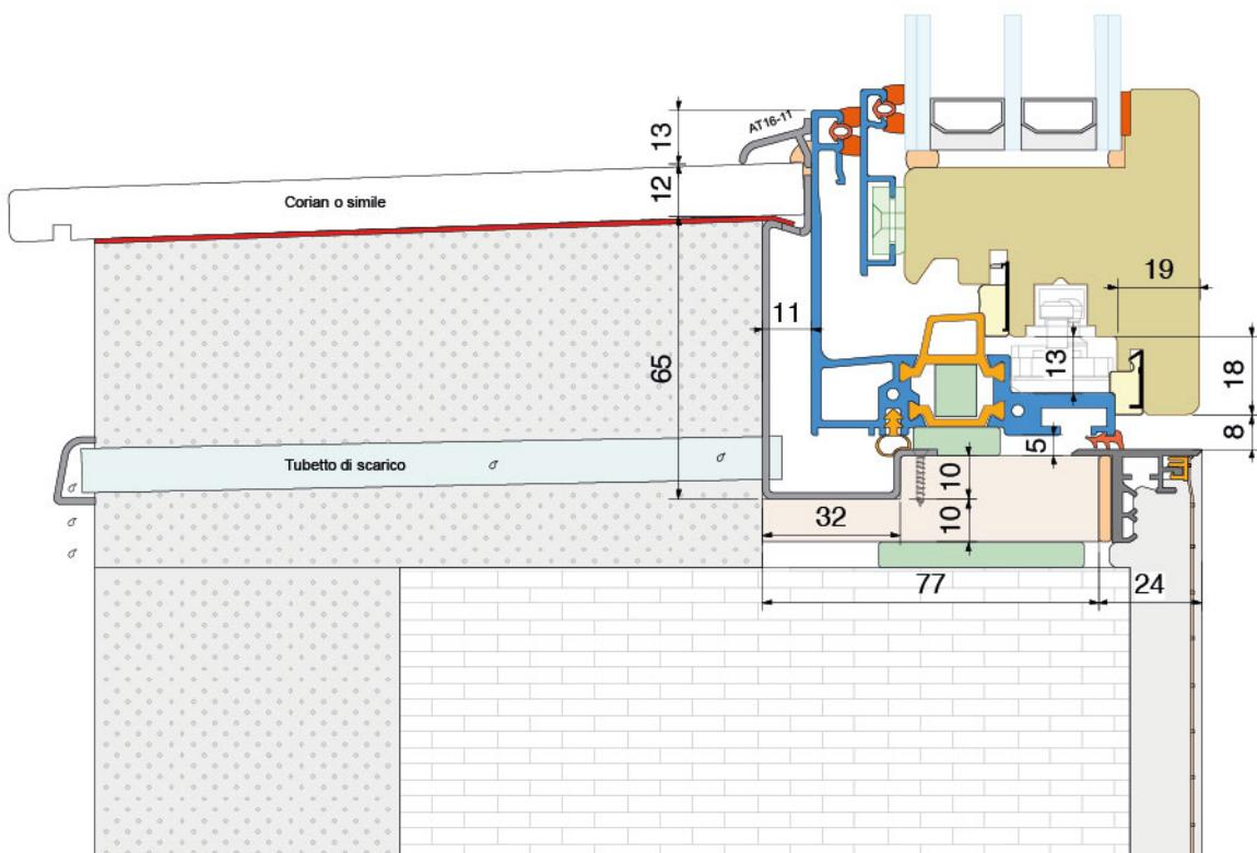
Sezione del montante laterale
