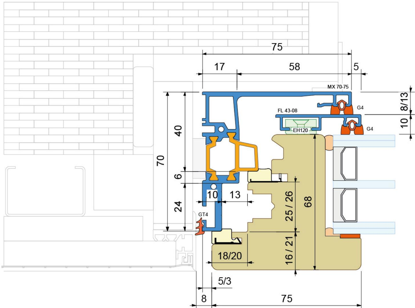
Sezione del montante laterale
