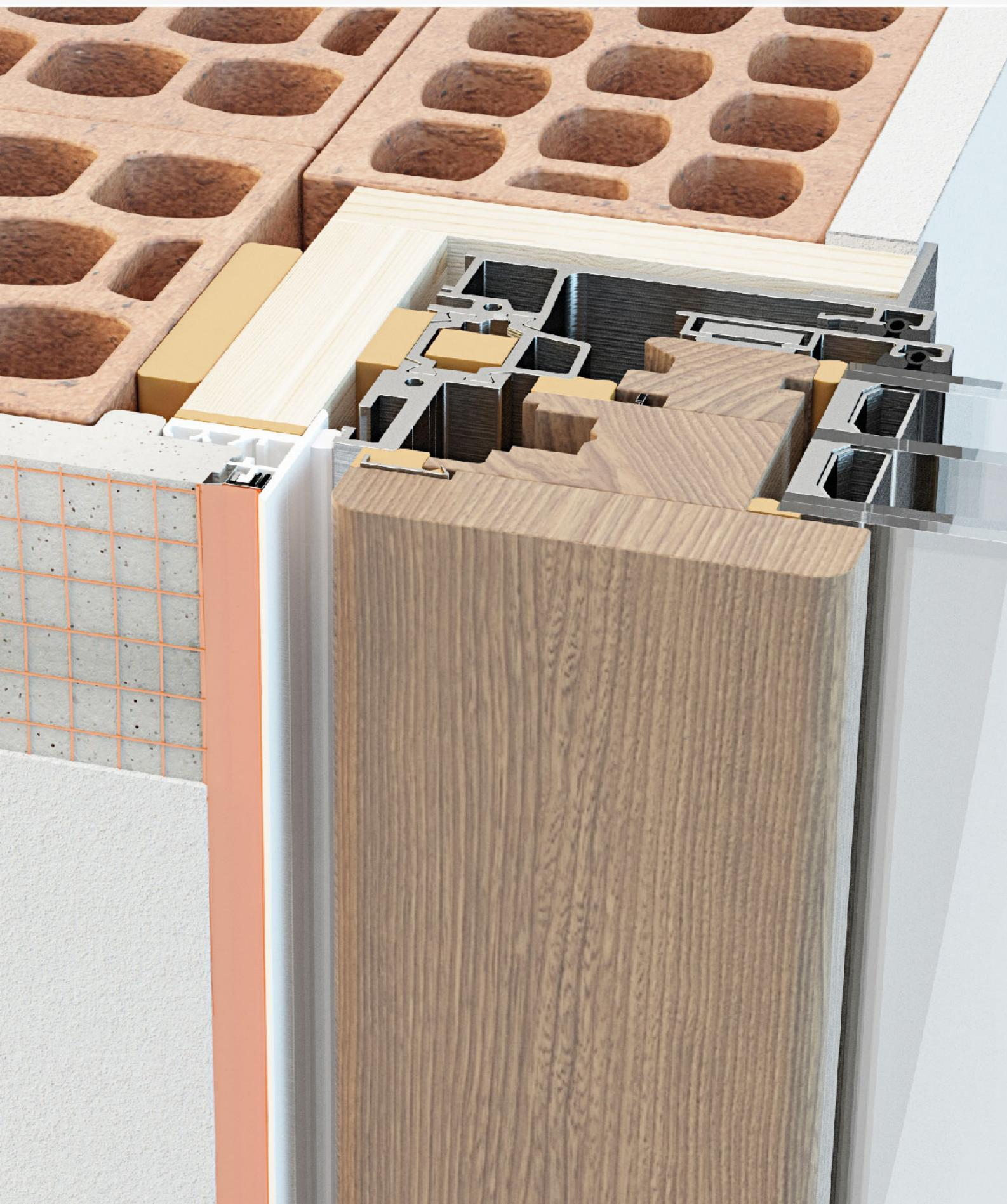
Sezione del montante laterale
