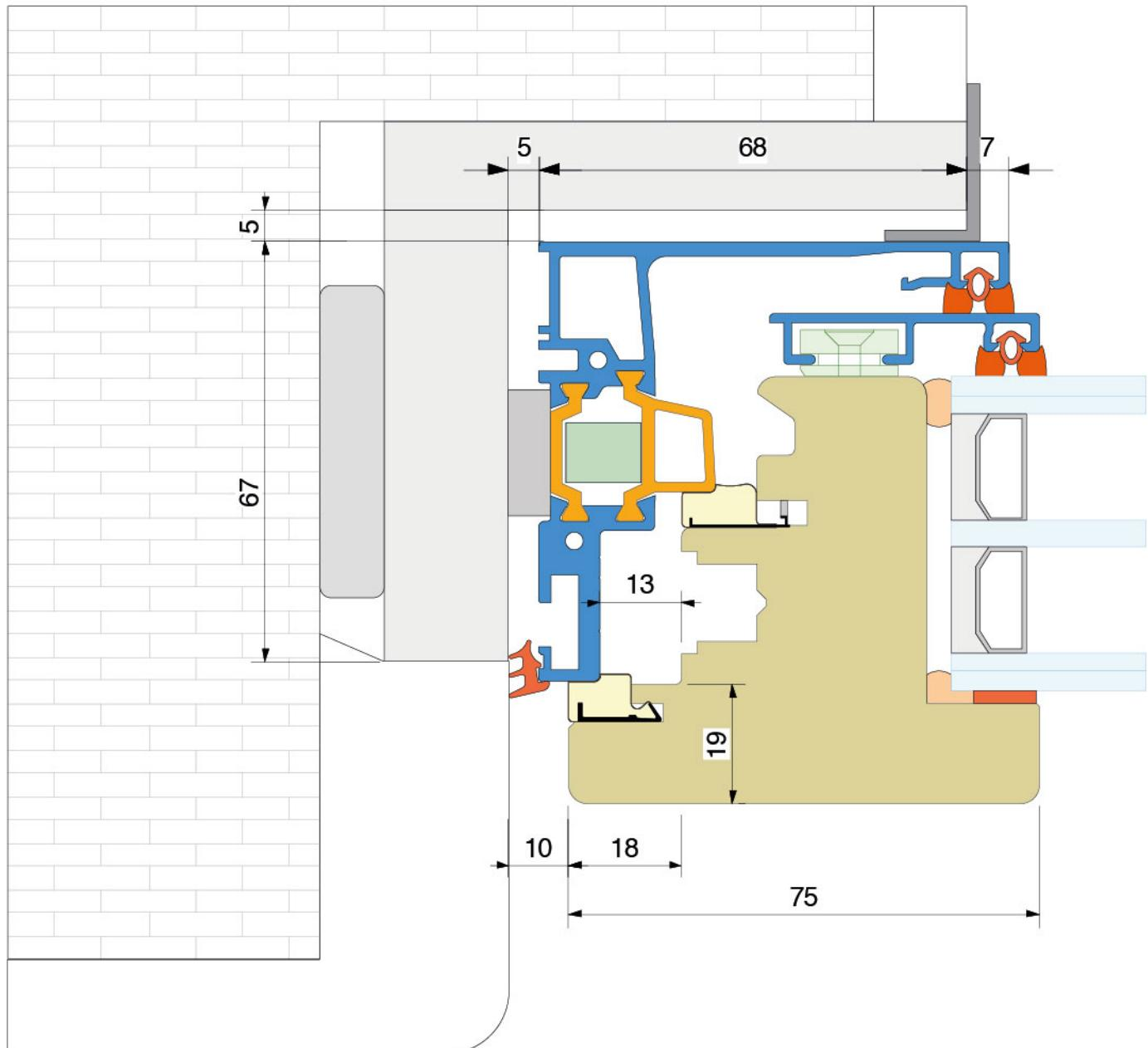
Nodo inferiore finestra. Installazione sopra il davanzale in alluminio.
